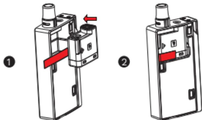
c. Wenn das Klebeband versehentlich in der Batterie verbleibt, heben Sie den POD gemäß der Pfeilanzeige auf dem Pod heraus.
