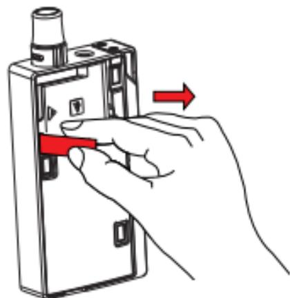
b. Bevor Sie den neuen POD in die Batterie einsetzen, stellen Sie bitte sicher, dass der Klebeband draußen bleibt.
